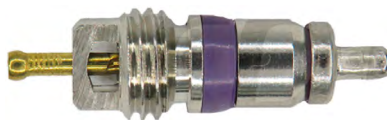
Tipo: Válvula de Carga M8 x 1 Comprimento: 22,10mm Aplicações: AUDI, MITSUBISHI, VW
